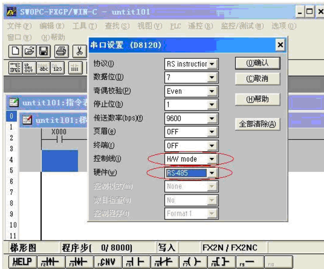
图 6 串口参数配置
