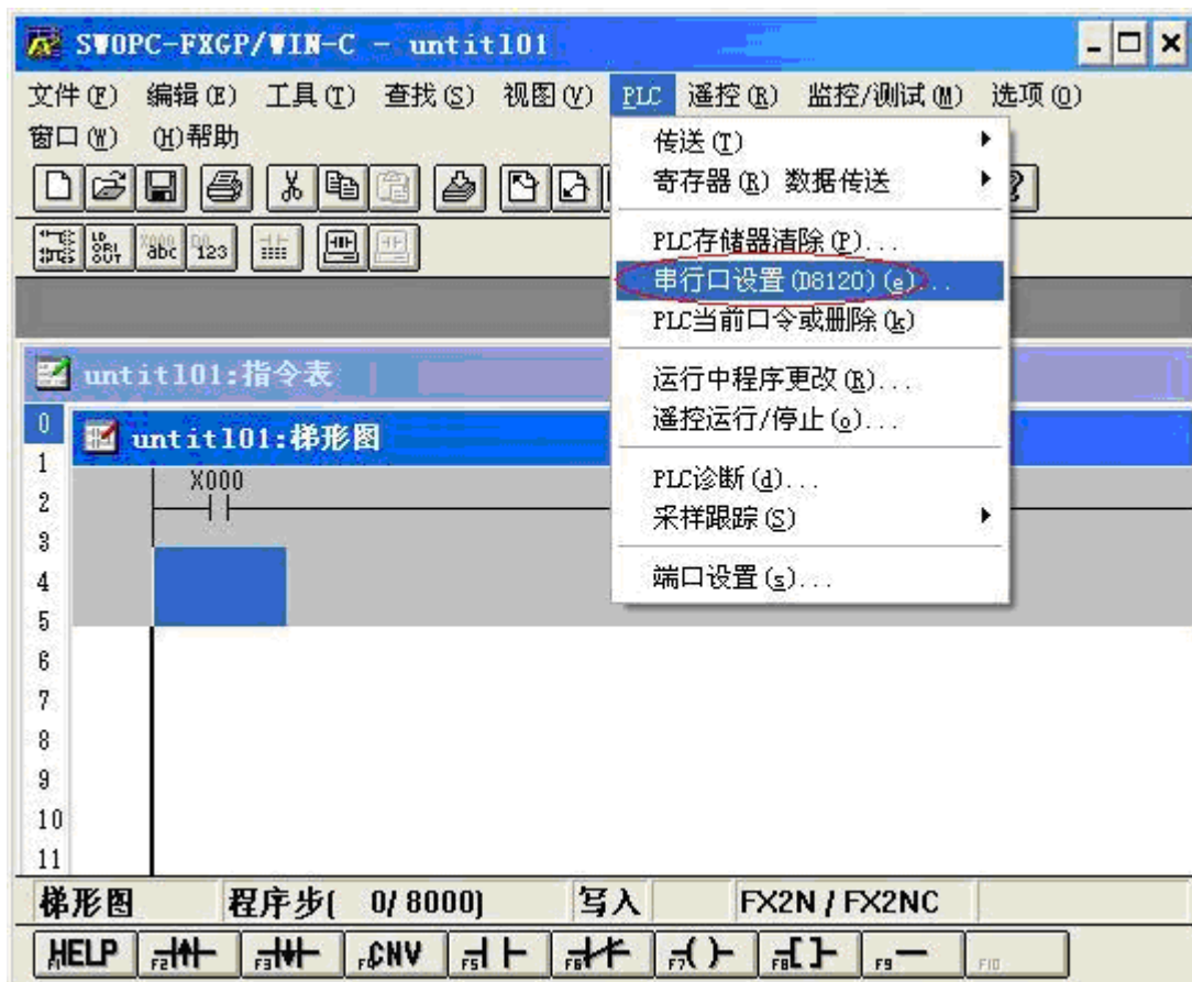
图 5 FXGP/WIN-C 编程软件串口通讯参数配置
