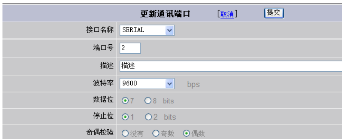
图 16 WebAccess 串口通讯端口参数
