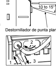
Orificio del terminal (inserción) Orificio de sujeción Virolas y cables sólidos
