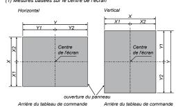
(2) Mesures pour le GOT à l'horizontale avec les raccords au-dessus et
