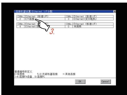
3. 要更改参数的设置时，触摸驱动程序显示栏。
