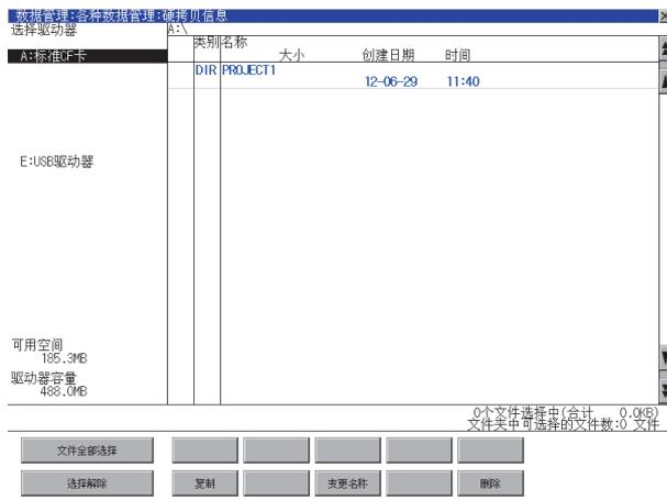
1. 触摸 [ 选择驱动器 ] 的驱动器后，将显示所触摸的驱动器内的信息。
