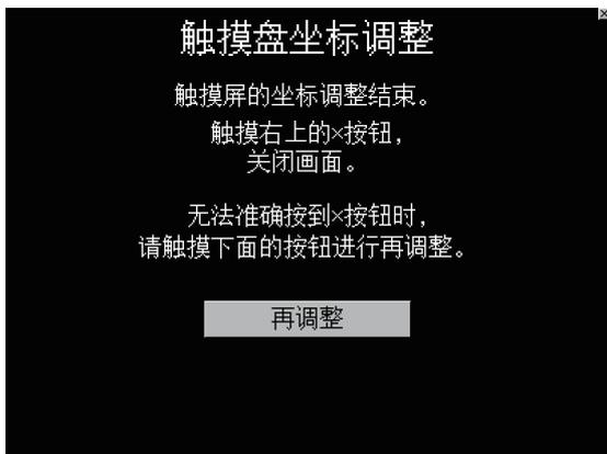
5. 触摸右上角显示的
