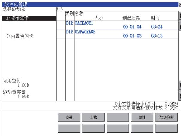
1. 触摸选择驱动器的驱动器后，将显示所触摸的驱动器的起始文件夹中的信息。
