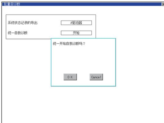
1. 触摸系统状态记录的导出的项目后，每次触摸时按 A 驱动器→ B 驱动器→ E 驱动器→不导出→ A 驱动器的顺序切换。
