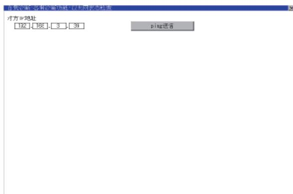
1. 触摸 [对方 IP 地址] 的选择按钮后,即弹出键盘。通过键盘输入对方的 IP 地址。
