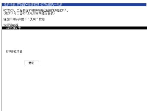
1. 触摸 [ 选择驱动器 ] 的驱动器后，所触摸的驱动器的名称所在的行变为反转显示。触摸 [ 复制 ] 按钮后，即开始复制。
