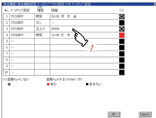
1. 触发备份的设置内容设置为时间时，触摸 [ 详细 ] 的设置项目后，切换到触发时间设置画面。
