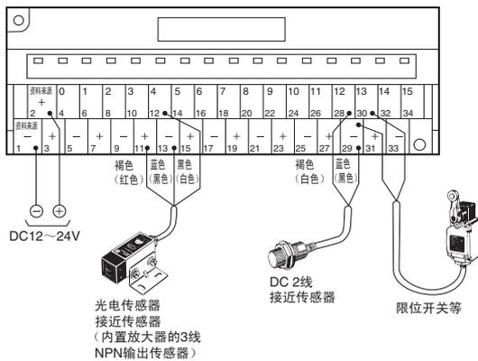
注: 已根据JIS标准的修订版更改光电传感器和接近传感器的芯线颜色。括号()中给出的是修订前的颜色。
