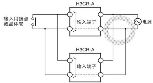
另外，即使相位一致，也不能如下图所示独立操作电源开关。（当一个定时器的电源开关ON时，输入ON后两个定时器都开始动作。）
