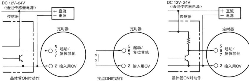
无电压输入的信号电平
