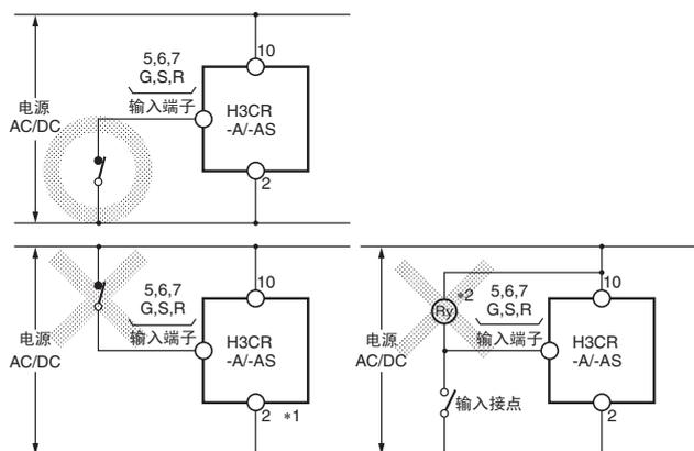
\*1. 电源端子2为输入信号的共通端子。请注意如果将10端子作为共通端子，会破坏内部回路。
