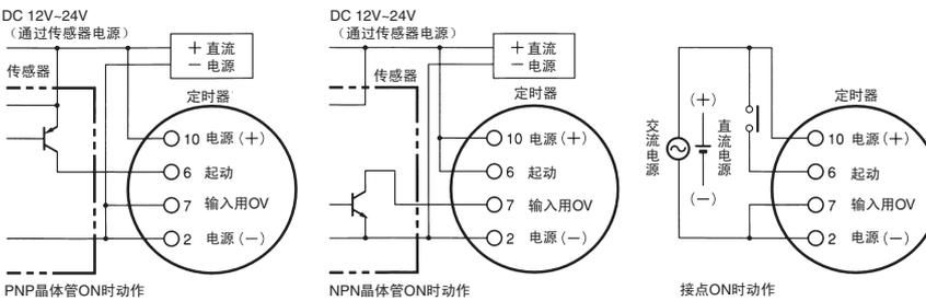
电压输入的信号电平
