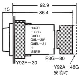
注：安装方向没有限制。
